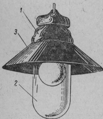
Рис. 38. Светильник фарфоровый полугерметический для наружной установки:
